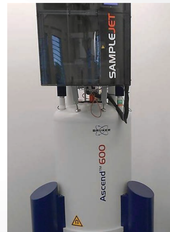
Obrázok 3: 600 MHz NMR spektrometer s autodávkačom SampleJet.
